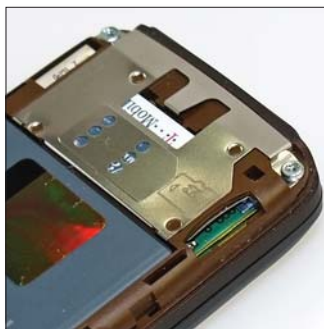
Sajnos memóriabővítés esetén le kell szednünk az akksifedelet. Szerencsére magát az akksit nem kell bántanunk.
