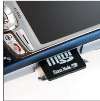
A 64 MB-os belső memória miniSD-kártyával bővíthető, amelyet sajnos külön kell a vásárlónak beszereznie, mert nem jár alaplóból a készülékhez.
