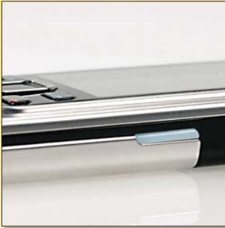
Elsőre talán nem is tűnik fel: a telefon két oldalán egy-egy kékszínű LED van elrejtve, amelyek fényhatással jelzik a beérkezett üzeneteket vagy éppen az elmulasztott hívásokat.
