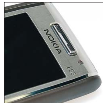
A jobb felső sarokban megbújó kis szenzor kiválóan érzékeli a környezet fényerejét, és kapcsolja ki/be a billentyűzétvilágítást.
