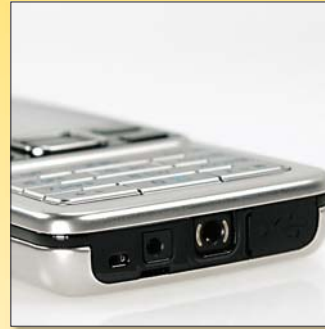
Alul három csatlakozóaljzat kapott helyet: a miniUSB-slot elegáns kis fedelet kapott, ellenben az akkumulátort és a 2,5 milliméteres headsetcsatlakozó csupaszon maradt.
