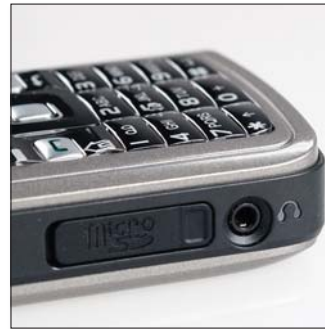
A készülék memóriája microSD-kártyával bővíthető. A kártyanyílás mellett található a fülhallgató csatlakozója.
