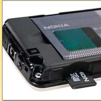
A finn mérnökök vélhetően nem kívánták egy résszel elrontítani a 6300 fém hátlapját, emiatt a parányi memóriakártyák cseréjéhez le kell venni a borítást, de a telefont nem kell újraindítani.
