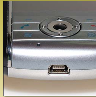
Alul egy teljesen szabványos miniUSB-csatlakozót helyeztek el a tervezők, ellenben kár, hogy az oldalsó audiocsatlakozó nem 3,5, hanem 2,5 milliméteres.
