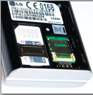
A belső memória 55 MB kapacitású és szerencsére bővíthető, azonban bosszantó, hogy a microSD-memóriakártyák cseréjéhez szét kell szedni a készüléket.
